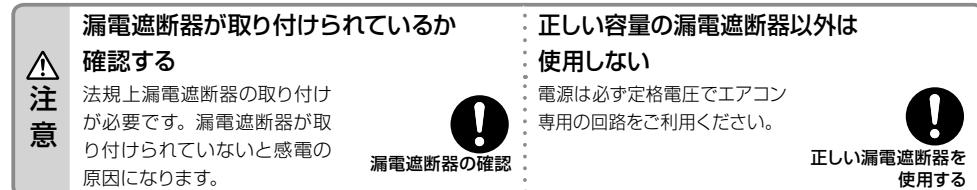
正しい漏電遮断器を使用する
