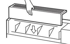
**5** 吹出口を固定ねじ2本で締め付ける
