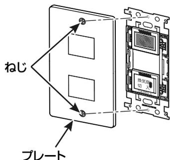
②結線図の通りに結線して、ねじ (2 本) でスイッチボックスに取り付けてください。
