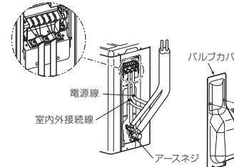
※電源線と室内外接続線は下記皮ムキ長さを守って必ず二重被覆部分をコードクランプでしっかりと固定してください。
