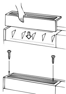
⑤必ずはずした固定ねじで締め付けて吹出口がはずれないようにしてください。
