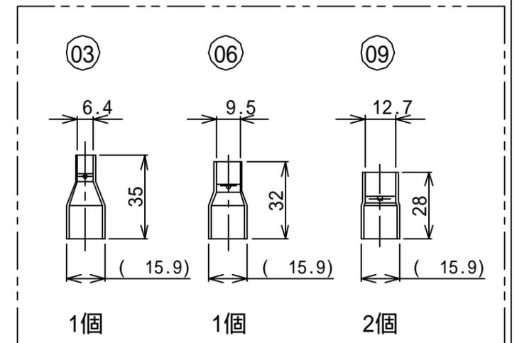
注：1．（外径）表示は表示位置の径を示し、それ以外は接続される配管の径を示します。
