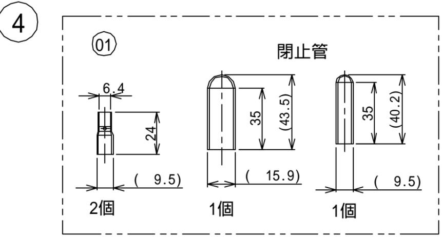
注：1．（外径）表示は表示位置の径を示し、それ以外は接続される配管の径を示します。
