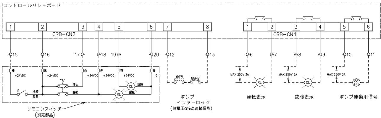
注、 端子台Tb7の#12,#13の間に、冷温水ポンプの電磁開閉器のα接点及びフロースイッチを直列に接続してください。
